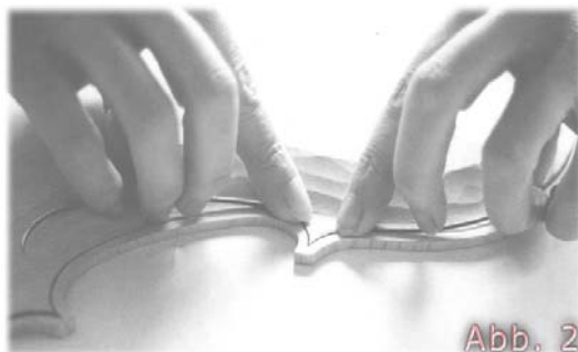
Die Einlagen werden eingesetzt.
